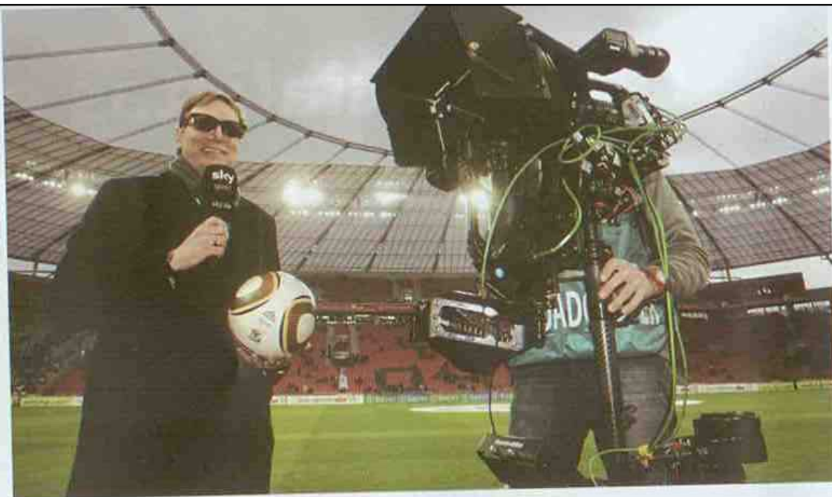
Graças ao fato de serem construídos em fibra de carbono, os Freestyle Rig, juntamente com os Standard Rigs da P+S Technik foram adotados pela Sky para as suas transmissões de futebol em 3-D
